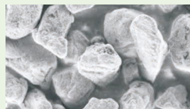
Рис. 3. Частицы тонера в совместимом картридже
